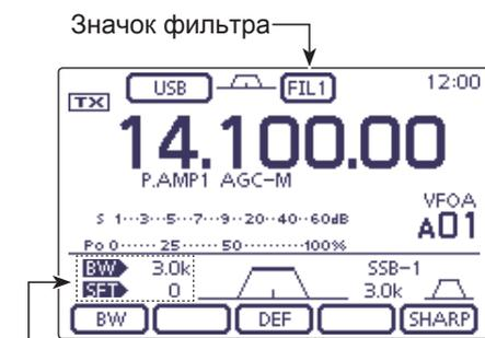
Ширина полосы пропускания и значение сдвига
