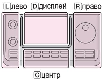
L, R, C или D в инструкции указывают на часть контроллера.
