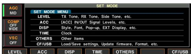
Режим установок используется, для программирования редко изменяемых значений или условий функций. IC-7800 имеет режим установки уровня, режим установки дисплея, режим установки времени, режим установки аксессуаров, другой режим установки и меню установки USB-памяти.
